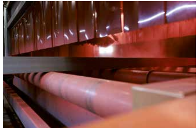
Vor der Beschichtung im Lackierautomaten ermitteln Sensoren die Werkstückabmessungen millimetergenau, um Ressourcen zu sparen.
