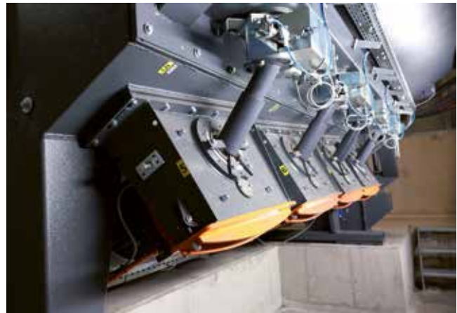
Die acht Hochleistungsturbinen mit Y-förmigen Wurfschaufeln sorgen für gleichbleibend hohe Strahlergebnisse.
