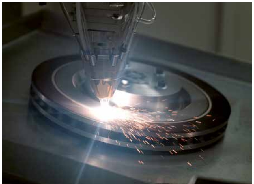
Beim Laserbeschichten von Brems Scheiben wird ein spezielles Metallpulver (häufig mit Karbiden) mit hoher Vorschubgeschwindigkeit und hoher Laserleistung auf die Brems Scheibe aufgetragen.
